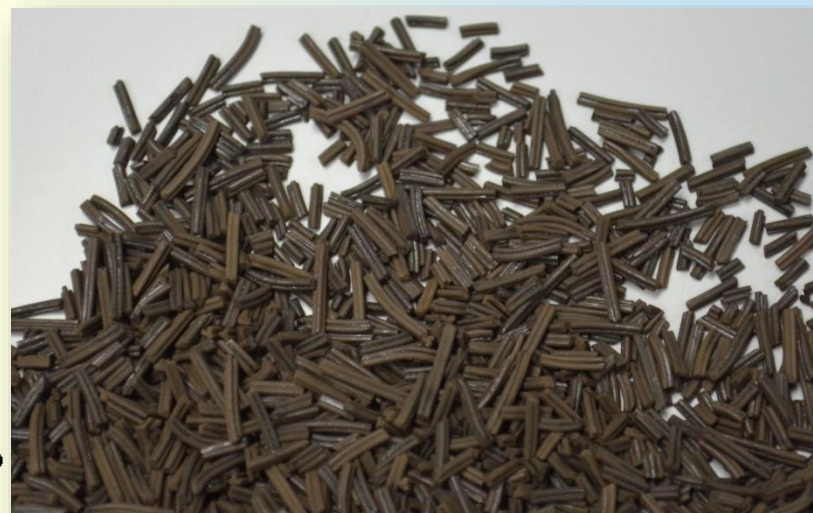
Внешний вид трехкомпонентного катализатора гидроочистки вакуумного газойля
